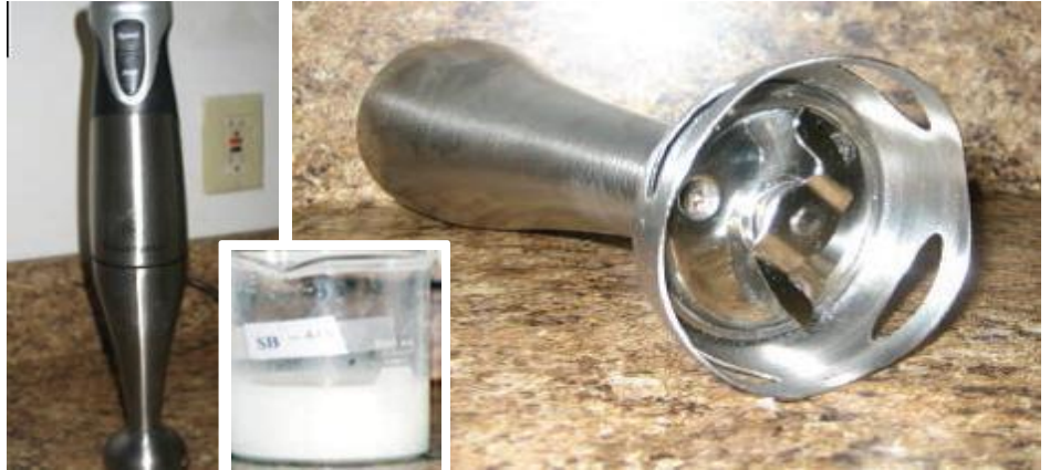
图 2: 实验室实验所用均质机和用 J208-412 做的乳液在 24 小时后的稳定性
